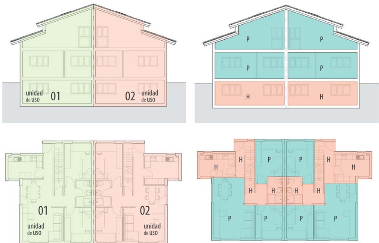
Figura A2.10. Planta y sección de viviendas unifamiliares adosadas. Unidades de uso y tipos de recintos
