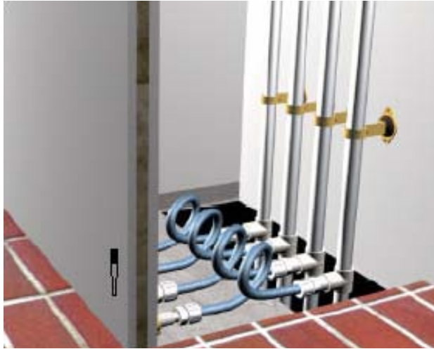
Figura CAL-05. Conectores flexibles
